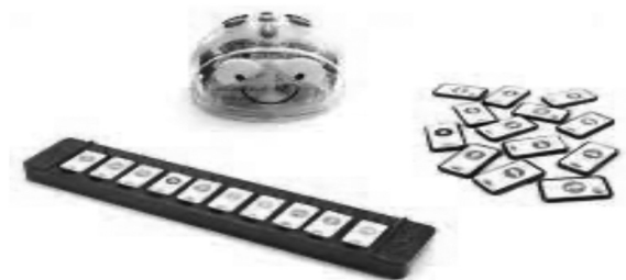
Figure 5 : Robot Blue-bot et sa barre de programmations avec ses cartes simples ou boucles
